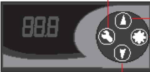
Ajuste la temperatura del refrigerador. Funciona cuando se pulsa el botón Ajustar para un periodo de 2 a 3 segundos.
