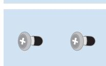
Pour permettre aux tôles de fixations situées à l'arrière du réfrigérateur de s'encastrer aux vis, il faut laisser une distance de 2-3 mm entre l'ancrage de vis et les têtes des vis.
